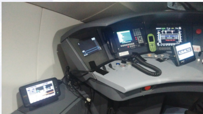
图28 安装在驾驶室高铁地震预警车载控车装置
